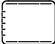
O alimento é aquecido simultaneamente a partir de cima e de baixo. Por exemplo, é apropriado para bolos, pastelaria ou bolos e estufados em formas de assar. 'Cook with one tray only' (Fogão com um só tabuleiro).
